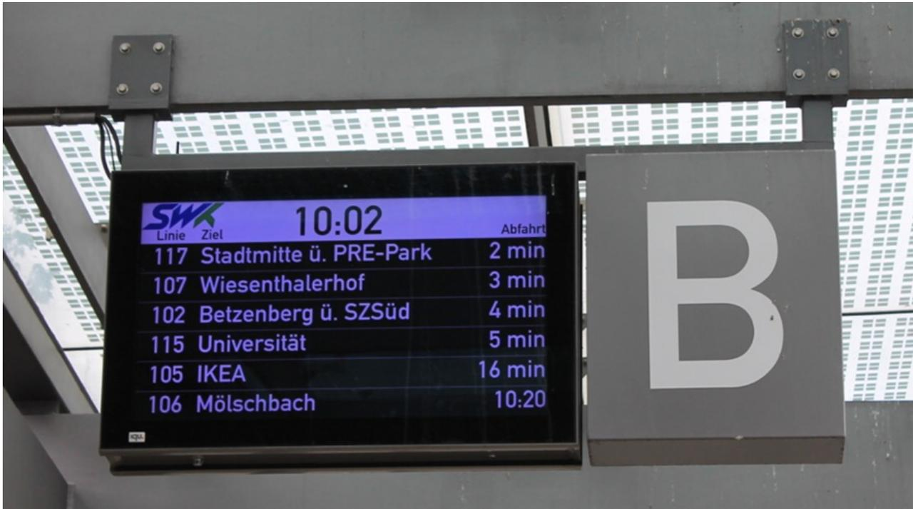
Abbildung 11: Echtzeit-Abfahrtsanzeiger des dynamischen Fahrgastinformationssystems
